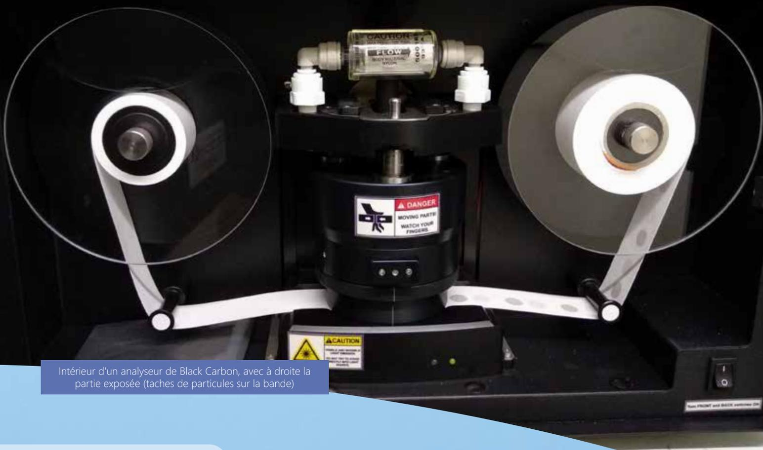
Intérieur d'un analyseur de Black Carbon, avec à droite la partie exposée (taches de particules sur la bande)
