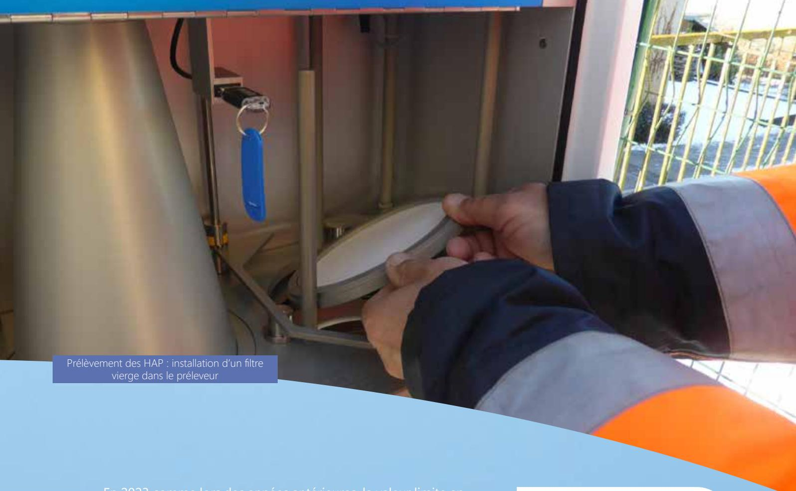
Prélèvement des HAP : installation d'un filtre vierge dans le préleveur
